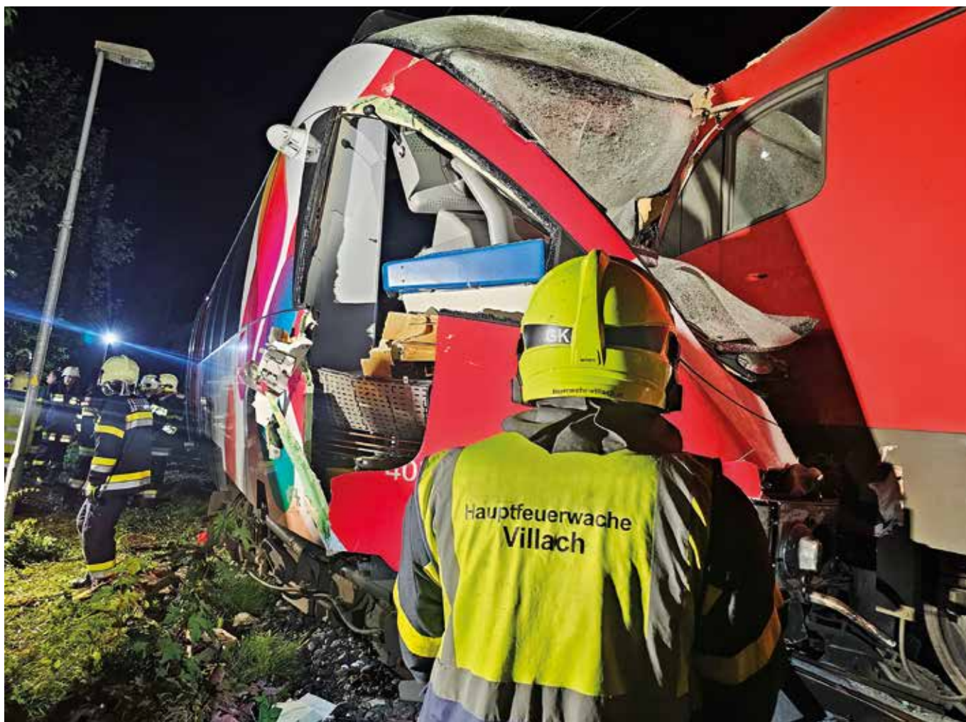
Blick auf die stark deformierten Zuggarnituren und den Führerstand, welche sich ineinander verkeilt.
